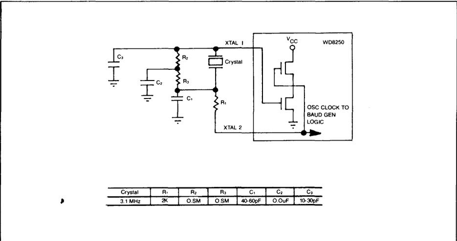
FIGURE 4. TYPICAL CRYSTAL OSCILLATOR NETWORK
